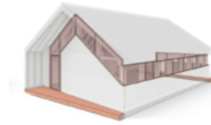
4. 문과 창문 배치, 출입구에 목재 데크 설치
