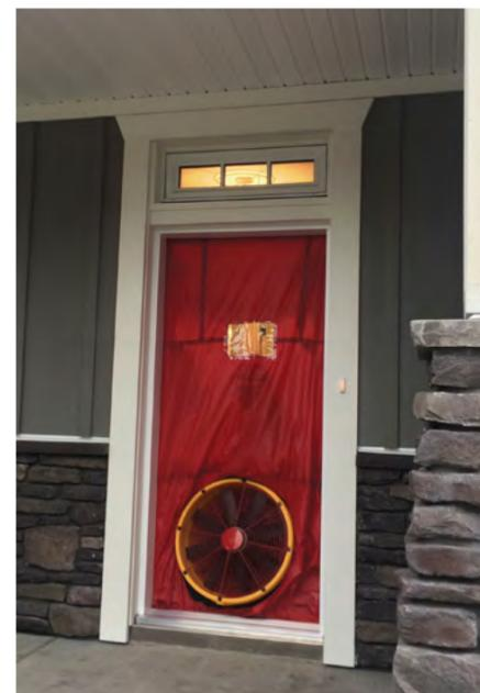
주택의 블로어도어 테스트 실시 모습
